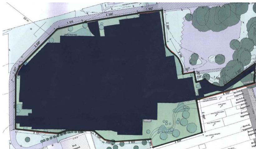
L'imperméabilisation du site. En bleu la surface construite en sous-sol et la surface rendue en tout ou partie imperméable.
