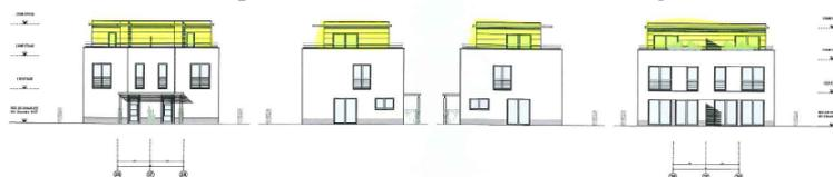
Bâtiment D : le gabarit de l'aile D (nord) passe de rez+1 à rez+2
