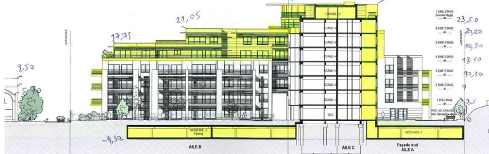
Elévation Sud : le gabarit de l'aile B (ouest) passe de rez +2 à rez +5 ; l'aile C (sud) est élargie sur toute sa hauteur
