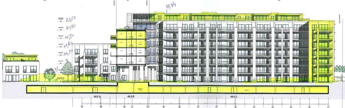
Elévation Ouest : le gabarit de l'aile C (sud) passe de rez+5 à rez +7 et est allongé vers le Sud
