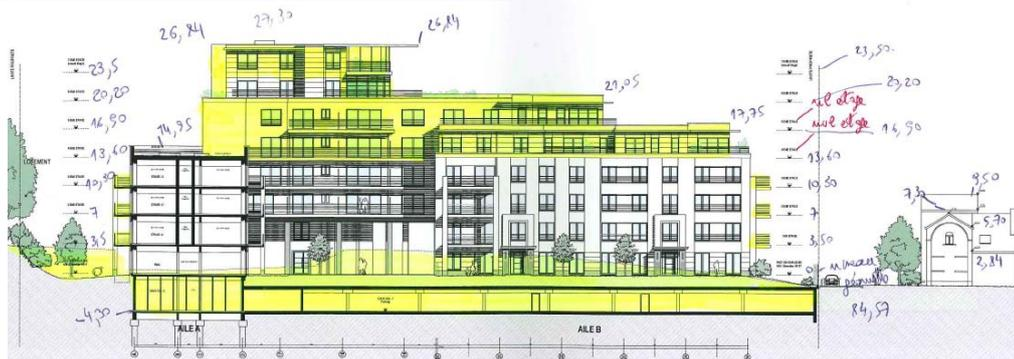
Elévation Nord : le gabarit de l'aile B (ouest), visible depuis la voirie, passe de rez +2 à rez +5
