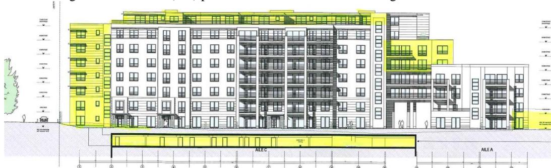
Elévation Est : le gabarit de l'aile C (sud) passe de rez+5 à rez +7 et est allongé vers le Sud
